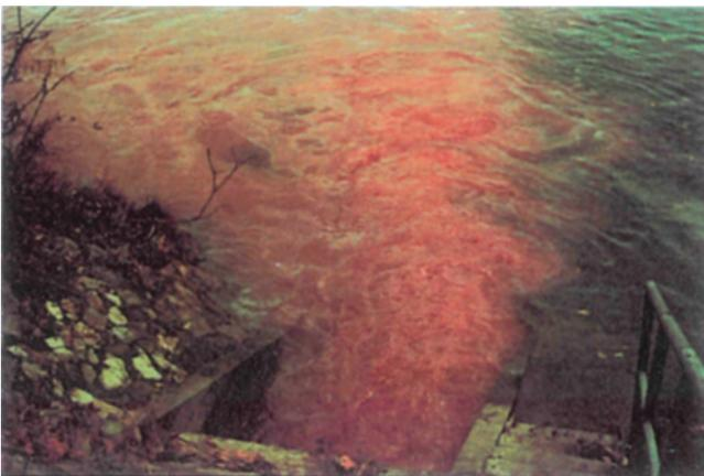
**E:** Kühlwasserauslauf in den Rhein – Eintrag von verunreinigtem Löschwasser, markiert mit dem roten Rhodamin-Farbstoff
