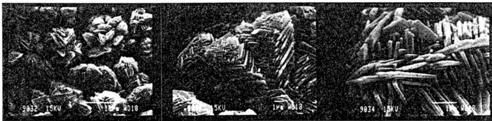
Abb. 7: Verschiedene Kristallaggregate von Kalziumsulfid ( \text{CaSO}_3 \times 1/2 \text{H}_2\text{O} )
