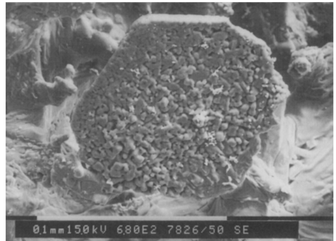
Abb. 3: Übergang vom Sinter- zum Schmelzvorgang an einem Grobaschenpartikel der Probe SP1 (SEM-Bild; 1 Balkenabschnitt = 0,1 mm)
