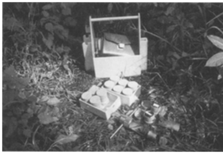
Abb. 2: Bodenstecher und Erdtransportdosen für Collembolenprobenahme
