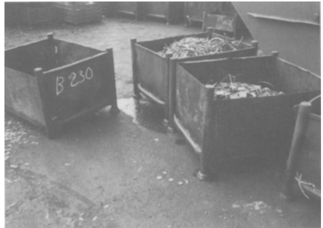
Abb. 3: Das aus Schrottcontainern ständig auslaufende Schneid- bzw. Bohröl führt langfristig zu einer Boden- und Grundwasserkontamination. Die allmähliche Einwirkung auf die Umwelt stellen die Geburtsstätten der zukünftigen Altlasten dar. (Foto: Dr. Peter EVERTS)
